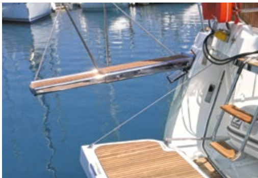
Retractable hydraulic passerelle / Passerelle hydraulique rétractable
